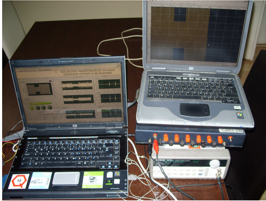
Şekil 5.16. Gerçek zamanlı dalgacık tabanlı ölçüm sistemi genel görünümü
