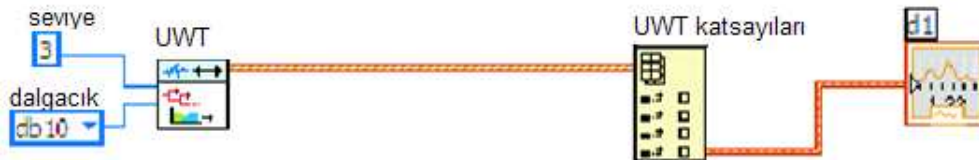
Şekil 4.19. 3 seviyeli db10 dalgacığı kullanarak UWT analizi
