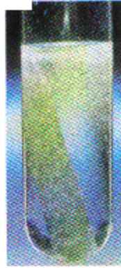
b. Çinko HCl ile tepkimeye girdiğinde H_2 gazı oluşur.
