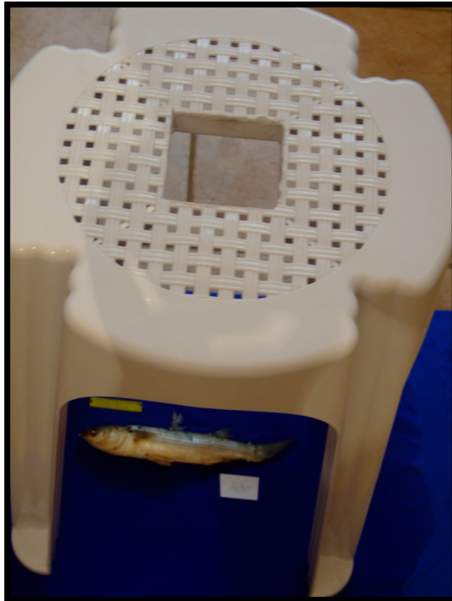
Şekil 8. Balık fotoğraflarının çekilmesi için hazırlanan düzenek
