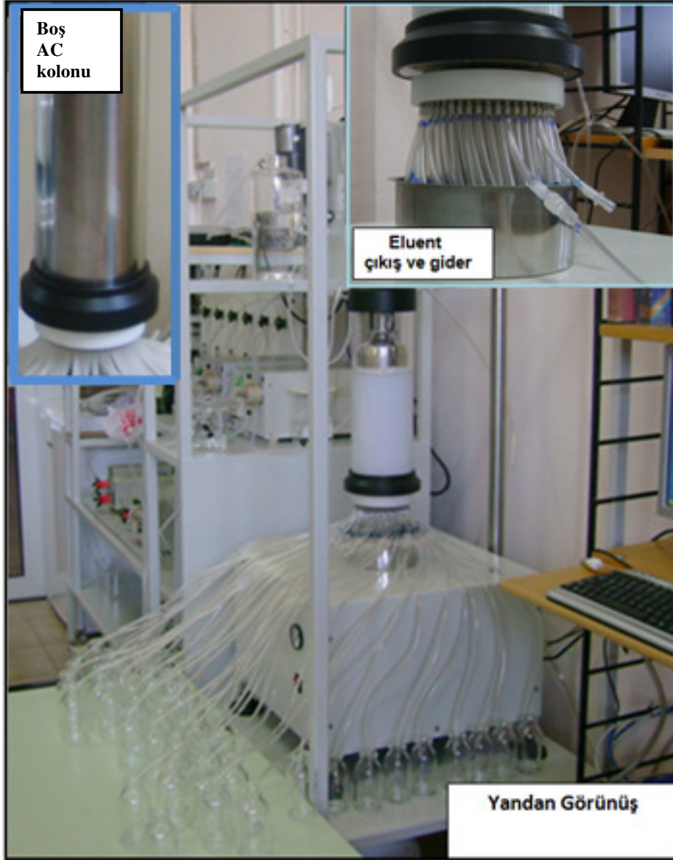
Şekil 4.5. İmal ettirilen döner annular kromatograf cihazına dair bazı detaylar.
