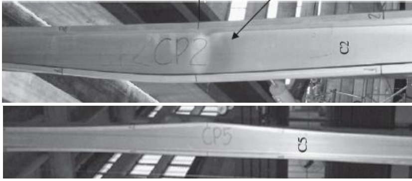
Şekil 48. Çarpılmalı ve genel burkulma modlarının birlikte gözlemlendiği kolonların deney sonrası durumları [22].
