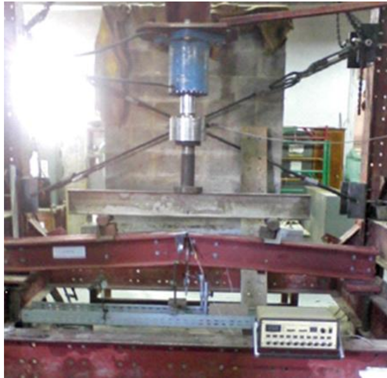
Şekil 41. Elkersh tarafından uygulanan tepe birleşim bölgesi deneyi [15].
