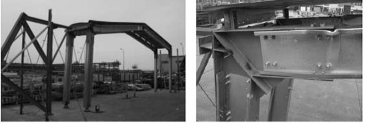
Şekil 42. Tam ölçekli çerçeveye ait deney düzeneği ve birleşimindeki yerel burkulma [16].
