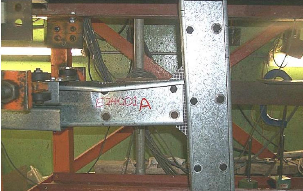
Şekil 44. Kolon-kiriş birleşim bölgesinin deney sonucu yanal göçmesi [18].
