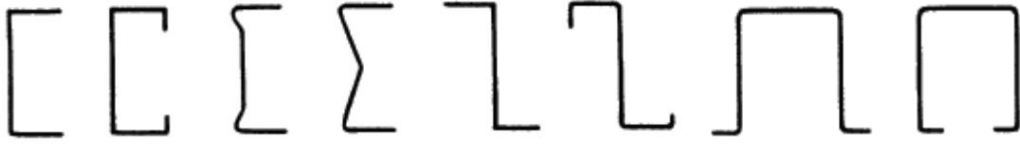
Şekil 21. Uygulamada en çok kullanılan bazı hafif profil tipleri
