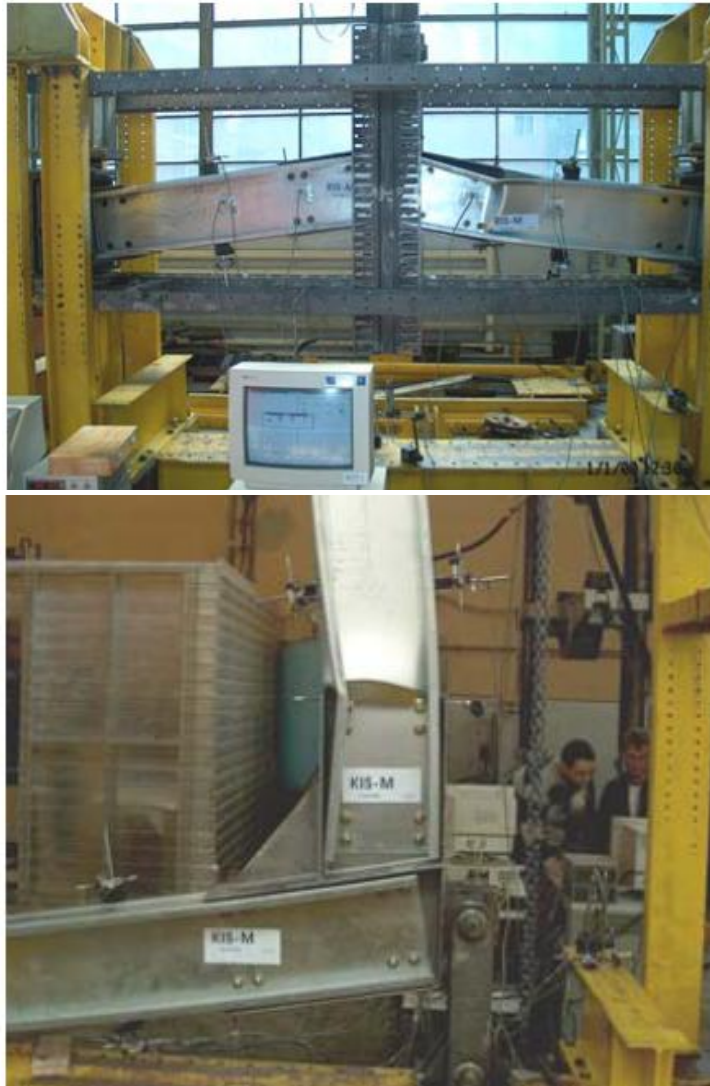
Şekil 40. Pernes ve Nagy tarafından uygulanan tepe ve köşe birleşim deneyleri [14].
