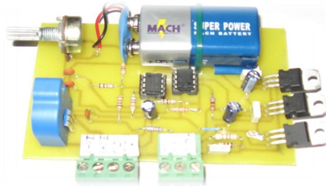
Şekil 113. Gerçekleştirilen akım okuma devresinin önden görünüşü
