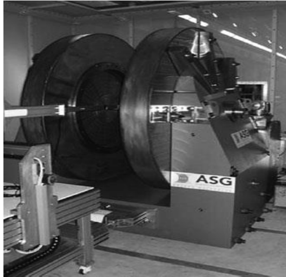
Şekil 1.15. ASG Superconductors şirketi tarafından MRI uygulamaları için geliştirilen (0,5 T) mıknatıs (Modica vd., 2007).
