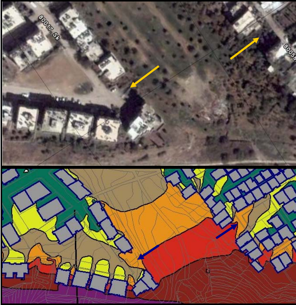
Şekil 5.5. Bina arkalarındaki bariyer etkisini zayıflatan boşluklar
