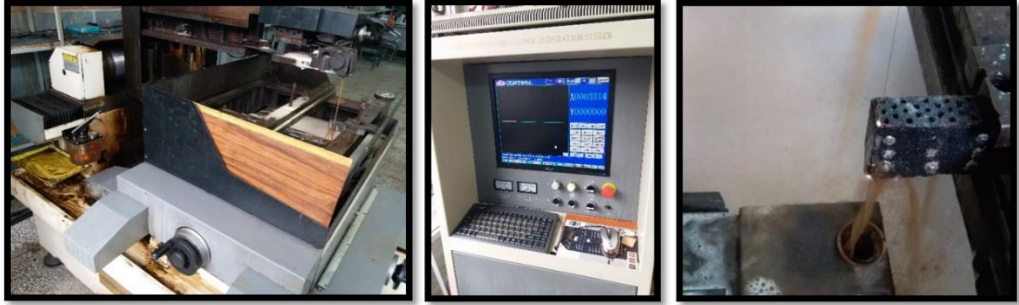
Şekil 3.3. Tel testeresi kesme makinası ve grafit köpüğün kesme işlemi
