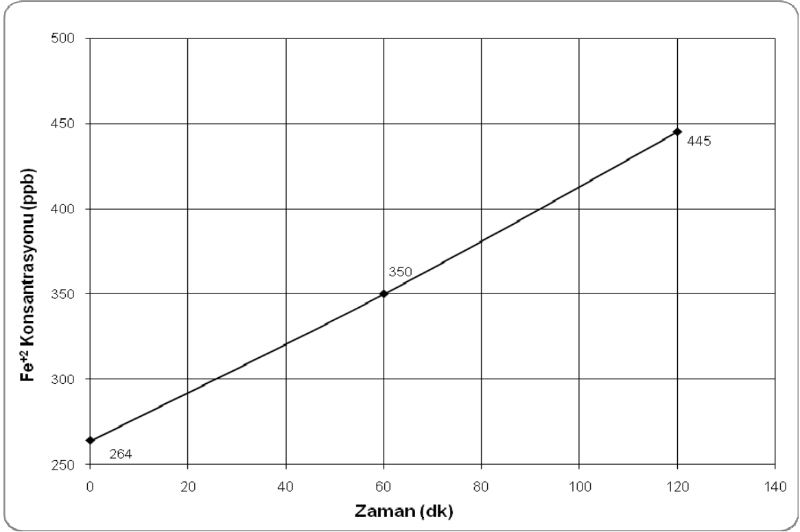
Şekil 4.11. 1 /25 karışım oranında 20 ml amonyum asetat tamponu ilavesi ile elde edilen sonuçlar.
