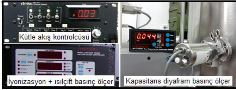
Şekil 3.2. Kütle akış kontrolcüsü, iyozasyon + ısılıçift basınç ölçer ve kapasitans diyafam basınç ölçer.
