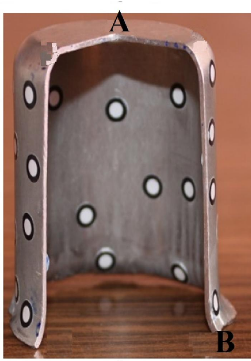
Şekil 27. Hidromekanik derin çekme işlemi sonucunda elde edilen ve üzerinden kalınlık ölçümü yapılan silindirik kap
