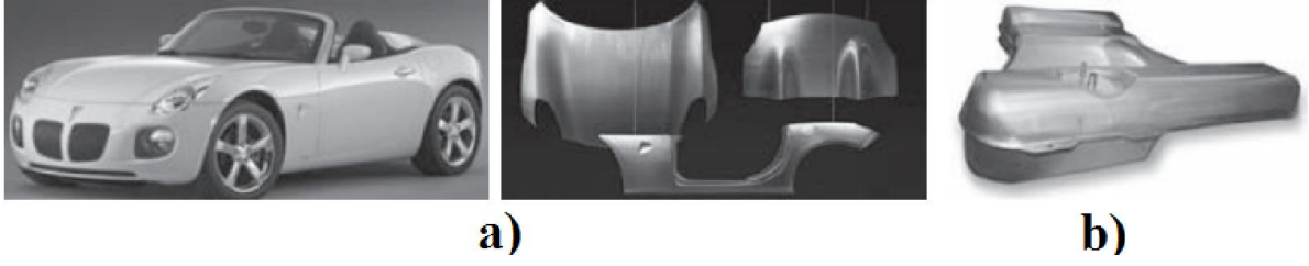
Şekil 7. Sac hidroşekillendirme prosesine ait endüstriyel örnekler: a) 2007 GM Pontiac Solstice GXP'ye ait çeşitli hidroşekillendirilmiş parçalar, b) tek adımda hidroşekillendirilmiş iki parçadan oluşan yakıt tankı [4]
