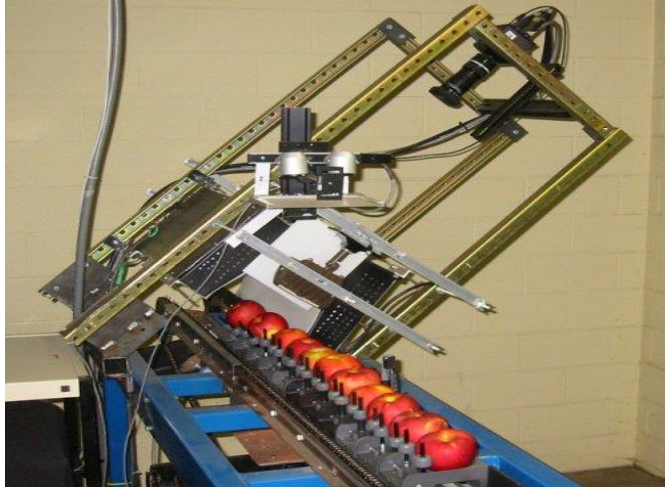
Şekil 1.6. Sıralama sistemleri (optik renk ayırma ve sıralama) [43]
