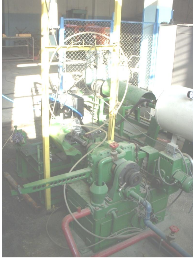
Şekil 4.1.Denemede kullanılan motor test ünitesi
