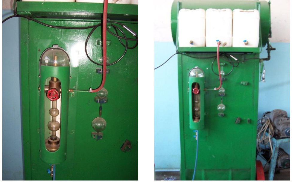
Şekil 4.4. Yakıt sarfiyatı ölçüm düzeni ve yakıt depoları
