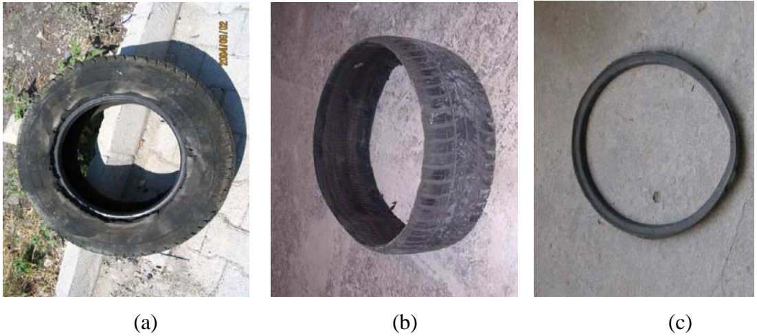
Şekil 5.1 Kullanılmış lastikler a. hurda lastik, b. sıyrılmış taban kısmı atığı, c. taban kısmı sıyrılmış atık
