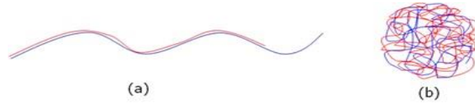
Şekil 17. PEK yapısına ilişkin modeller: (a) moleküler düzeyde eşleşme (b) yumak oluşumu modeli (mavi ve kırmızı renkler zıt yüke sahip polielektrolitleri ifade etmektedir) (Michaels vd., 1961).
