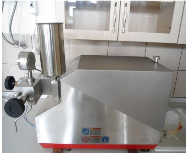
Şekil 27. APV-1000 yüksek basınçlı homojenleştirici
