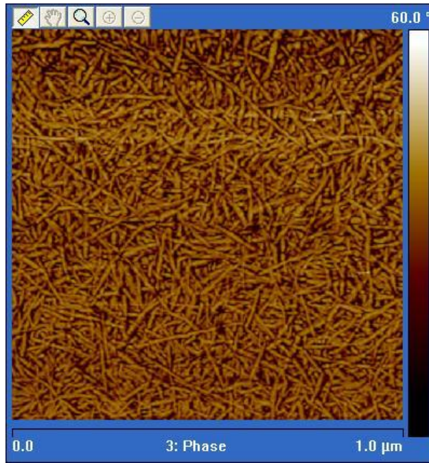
Şekil 34. Üretilen NFS'nin SiO 2 kristali yüzeyine kaplanması sonrasında elde edilen AKM görüntüsü (phase modü).
