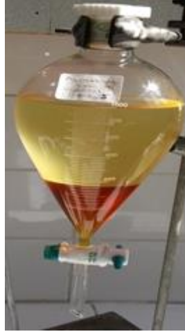
Şekil 3.4. Ayırma hunisine alınan gliserinin biyodizelden ayrılması
