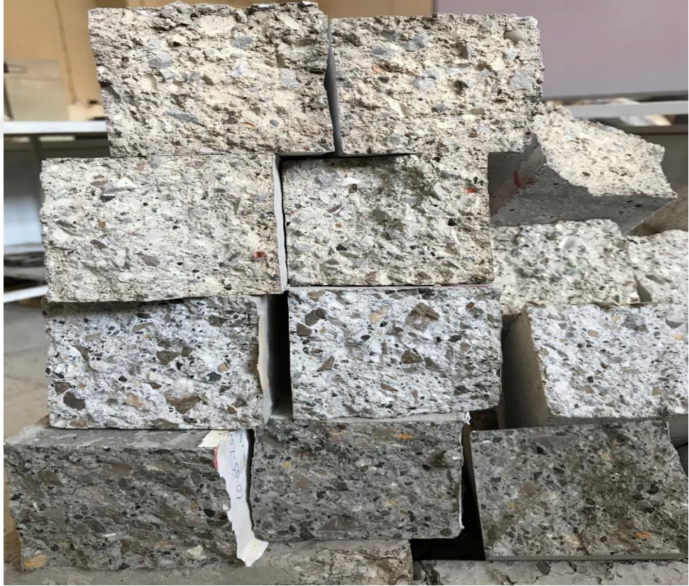
Şekil 4.13. Numuneler üzerinde gözlemlenen agrega dağılımı
