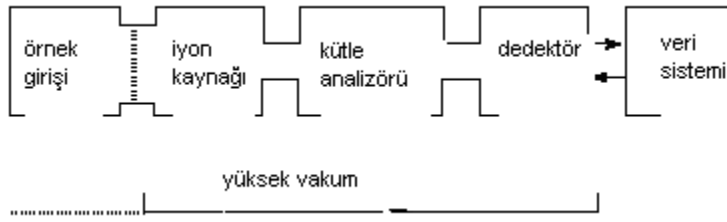
Şekil 2.3. Kütle spektrometresinin genel gösterimi (Gross,2004)
