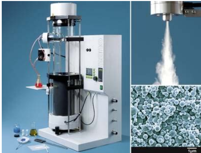
Şekil 2.9. Püskürterek kurutma cihazı ve üretilen nanopartiküller [81].
