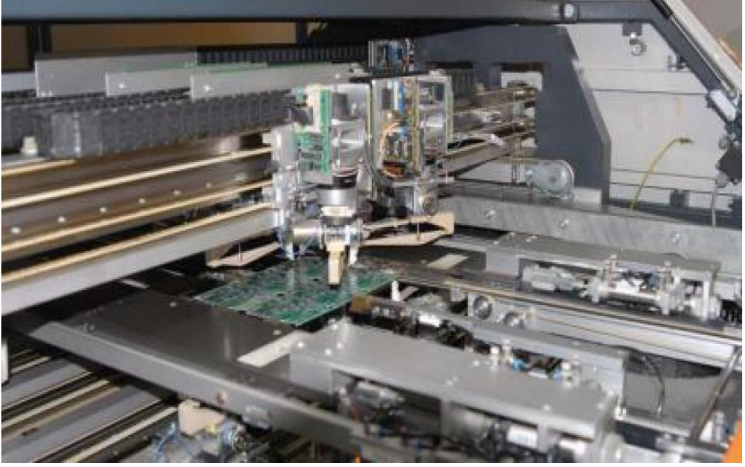
Şekil 13. Elektronik elemanları baskı devresine yerleştiren doğrusal hareketli motor
