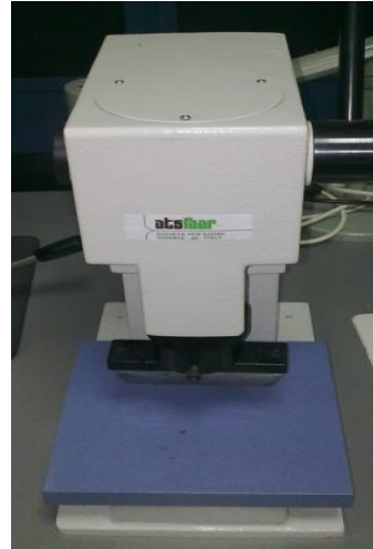
Şekil 3.3. Kuru formdaki bakteri selülozunu kesmek için kullanılan kesme aparatı
