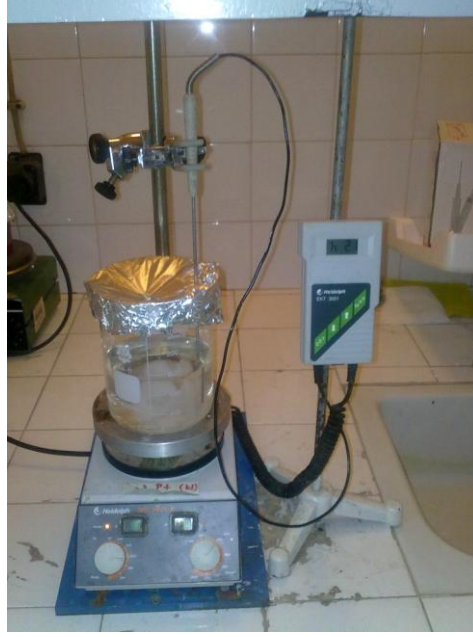
Şekil 3.2. Bakteri selülozunu temizlemek için kullanılan düzenek
