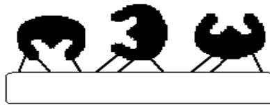
Şekil 2.26. Katı desteğe kovalent bağlanmış enzimlerin şematik gösterimi
