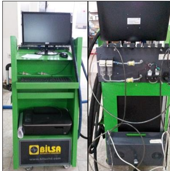
Şekil 2.7. Egzoz gazı analiz cihazı
