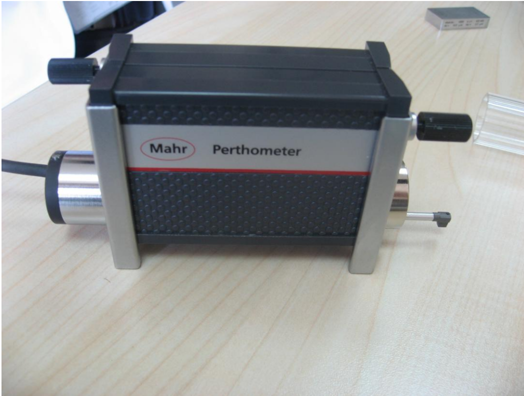
Şekil 3.6. Kullanılan Perthometer M2 yüzey pürüzlülük ölçüm cihazı.
