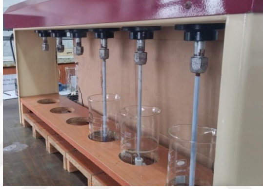
Şekil 23. Dijital hız göstergeli çoklu mekanik karıştırıcı
