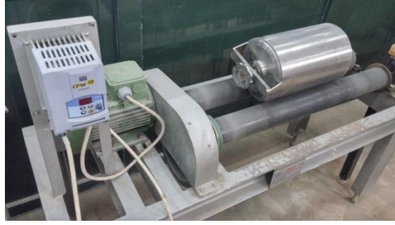
Şekil 17. Öğütme işleminde kullanılan çubuklu değirmen
