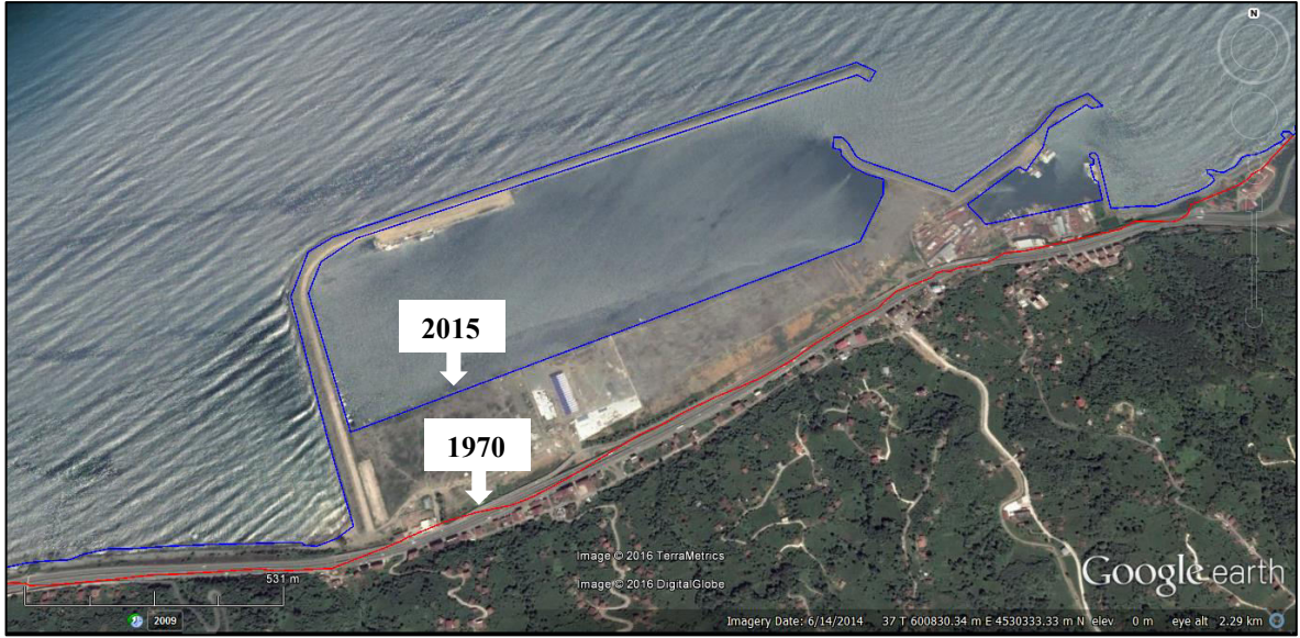
Şekil 61. Sürmene ilçesi Yeniay-Çambunu dolgu alanı uydu görüntüsü ve kıyı çizgisi değişimi (Google Earth, 2014)
