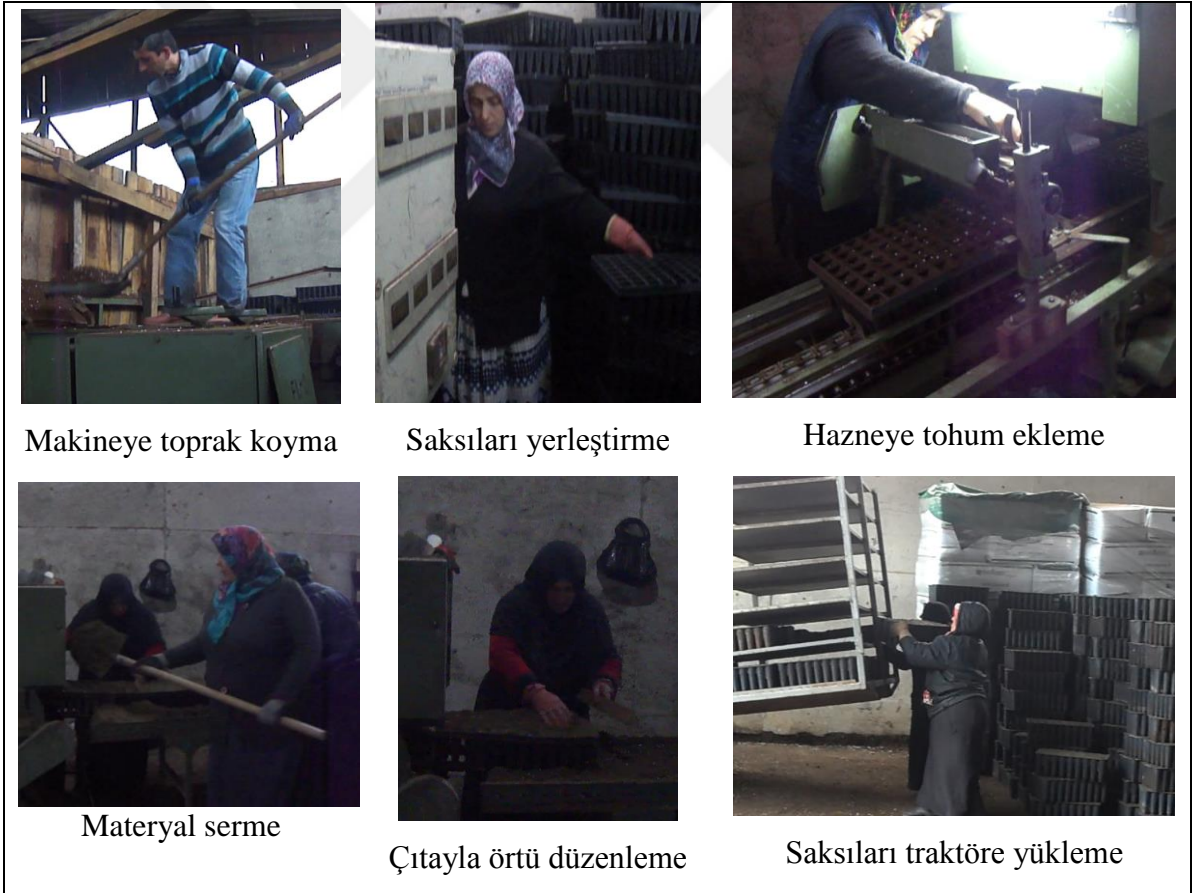
Şekil 2. Makineyle tohum ekimi aşamaları
