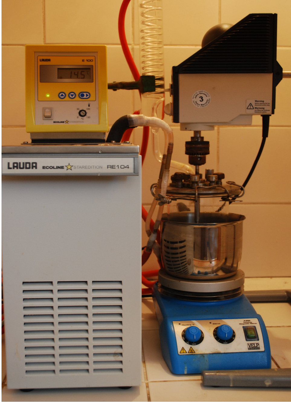
Şekil 4.1. Asidik hidroliz tepkimelerinin gerçekleştirildiği deney sistemi
