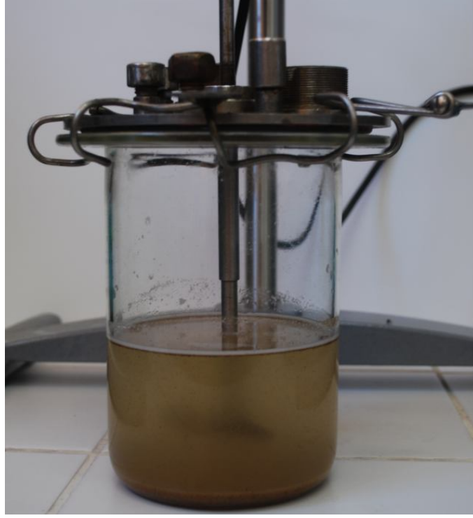
Şekil 4.2. Asidik hidroliz tepkimelerinin gerçekleştirildiği reaktör
