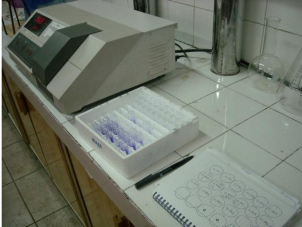
Şekil 3.23. Etanol – Asetik Asit solüsyonu içerisinde çözünen Kristal Viyole miktarının, 540 nm'de spektrofometre cihazında saptanması
