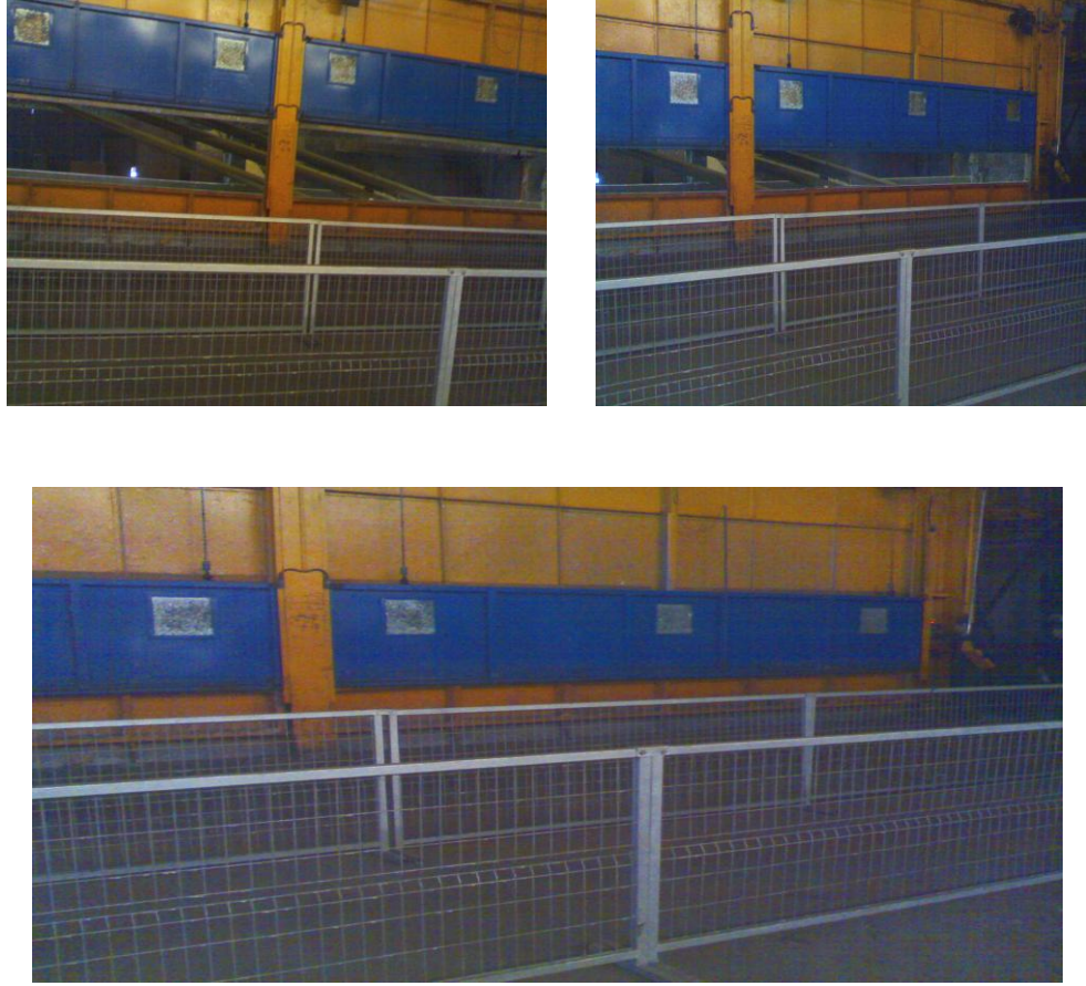
Şekil 3.1. Galvanizasyon banyo ünitesinde koruma mekanizması.
