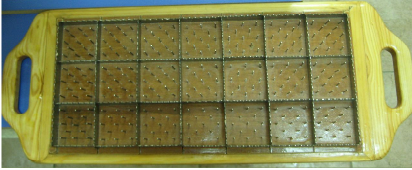
Őekil 4.5. Kraker kalıbı
