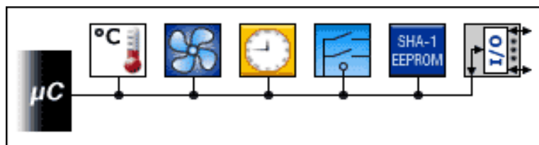
Şekil 2.12. 1-Wire Bağlantı Şeması [27]
