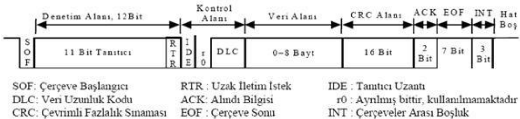
Şekil 2.10. CAN-bus Protokolü Veri Paketi Gösterimi [23]
