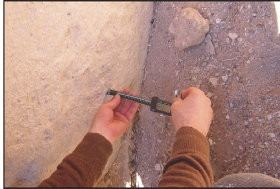
Şekil 5.16. Zelve 1. Vadi'de seçilen yerlerde aşınmanın belirlenmesi amacıyla (a) kaya yüzeylerine paslanmaz çivilerin yerleştirilmesi için delik açılması, (b) yerleştirilen çivilerin dizilimi ve (c) dijital kompasla çivilerden ölçüm alınması.
