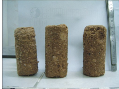
Şekil 6.13. Zelve Açık Hava Müzesi'nde yüzeylenen Zelve tufünün donma-çözülme deneylerinin 5, 10, 15 ve 20. çevrimler sonrasındaki durumları.
