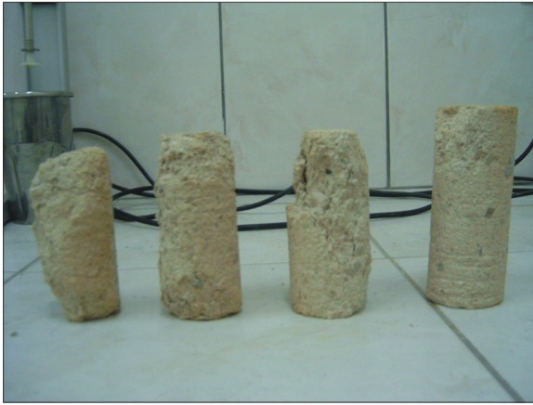
Şekil 6.10. Zelve Açık Hava Müzesi'nde yüzeylenen Zelve tufünün ıslanma - kuruma deneylerinin 2, 5, 8 ve 10. çevrimler sonrasındaki durumları.
