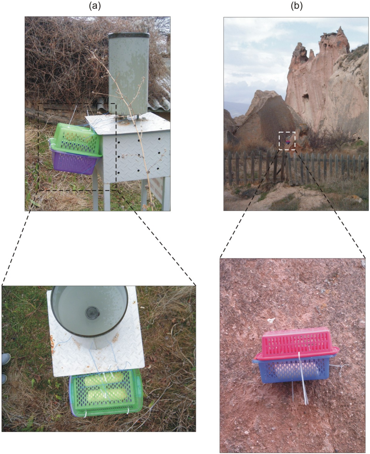
Şekil 6.15. Atmosferik etkilerin Zelve tüfü üzerindeki etkilerinin araştırılması amacıyla Zelve Açık Hava Müzesi'nde (a) meteoroloji istasyonunun üzerine ve (b) vadi tabanında yer alan blok üzerine yerleştirilmiş plastik kafesler içindeki karotlar.
