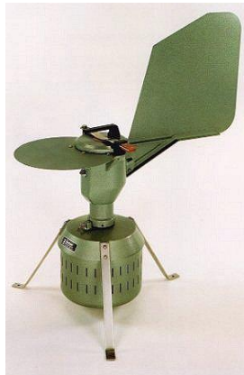
Şekil 3. 1. Burkard polen ve spor tuzaklama aracının genel görünüşü.
