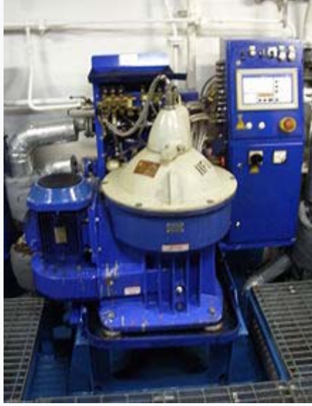
Şekil 1.10.Yağ ve yakıt arıtmada kullanılan bir seperatör
