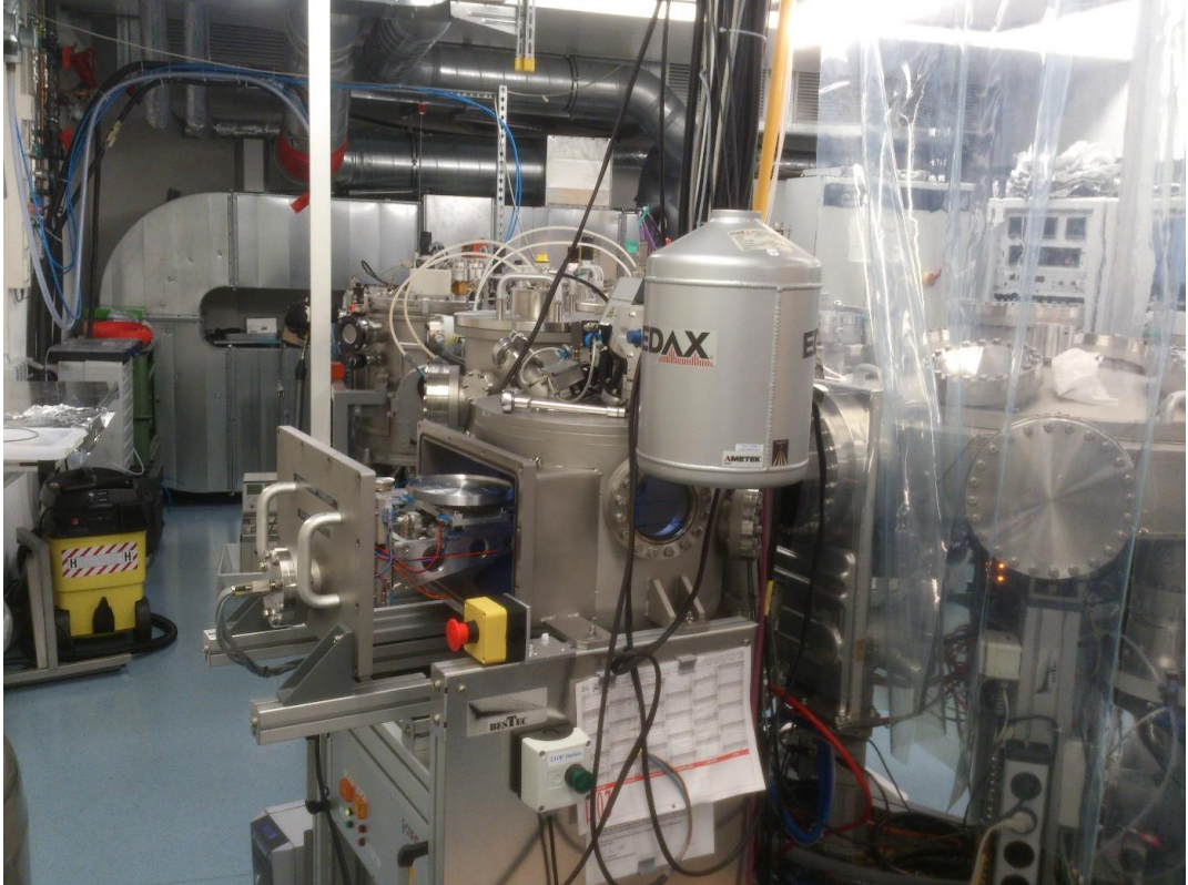
Şekil 2.7. Kimyasal kompozisyon ölçümü için kullanılan XRF (EDAX) cihazı
