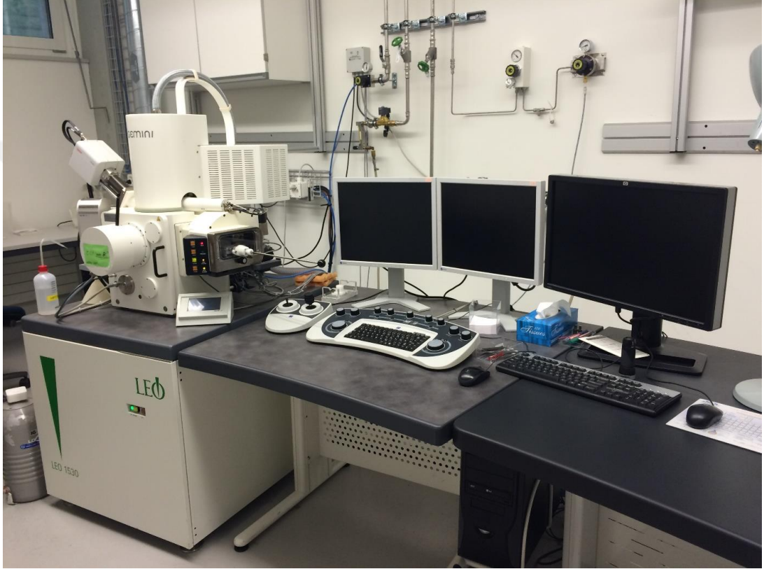
Şekil 2.11. Gemini Leo 1530 Taramalı Elektron Mikroskopi (URL-7, 2016).
