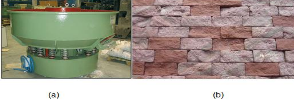
Şekil 2.4 Tamburlu eskitme ünitesi (a) ve eskitilmiş yüzey (b) (Özçelik ve Costa, 2010)
