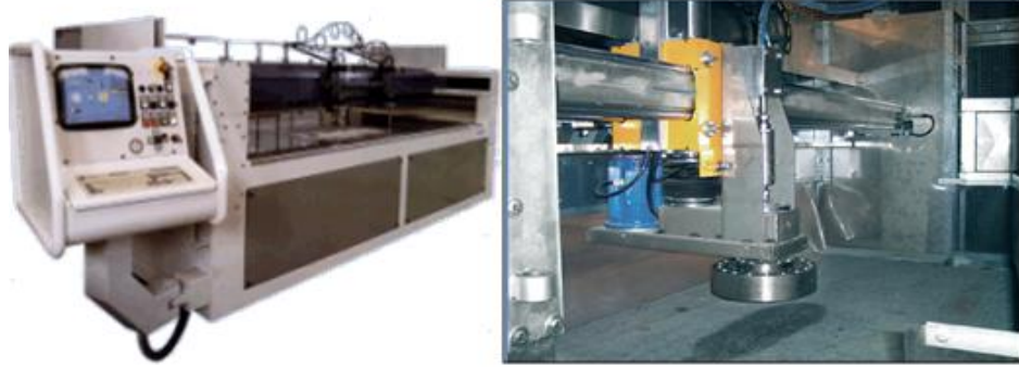
Şekil 3.2 Çalışmada kullanılan su jeti ile yüzey işleme makinesi (Özçelik ve Costa, 2010)
