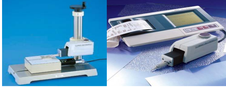
Şekil 3.3 Mitutoyo SJ-400 pürüzlülük ve yüzey yüksekliği ölçme cihazı (Özçelik ve Costa, 2010)
