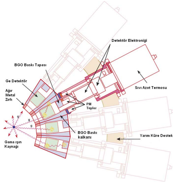
Şekil 3.13 Compton baskı kalkanlı HPGe dedektörlerinin şematik gösterimi (Eberth ve Simpson 2008)
