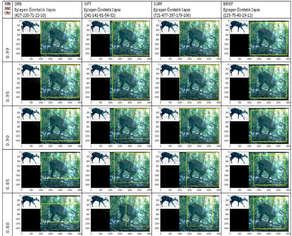
Şekil 3.26. k en yakın komşu eşleştirme işlemi ile eşik değere göre öznitelik eleme sonrası sınırlayıcı kutu değişimi
