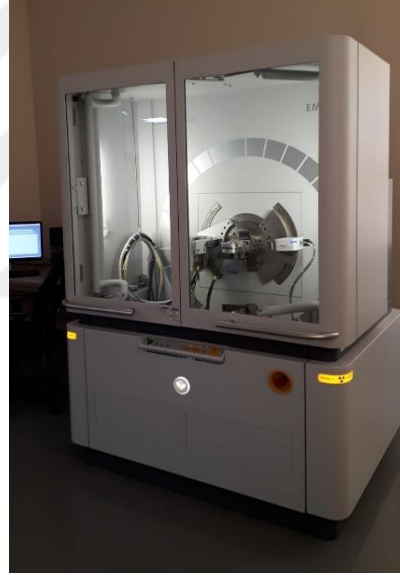
Şekil 3.7. Kaplamaların kristal yapı analizinde kullanılan XRD cihazı
