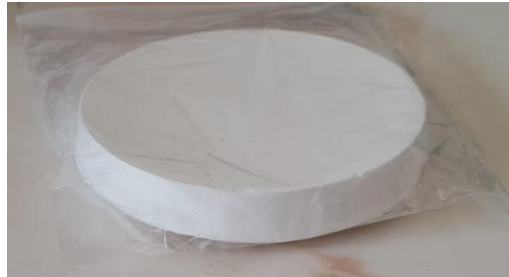
Şekil 3.1. Sinterleme sonrası elde edilen \text{Lu}_2\text{O}_3 hedef malzemede meydana gelen şekilsel bozulma
