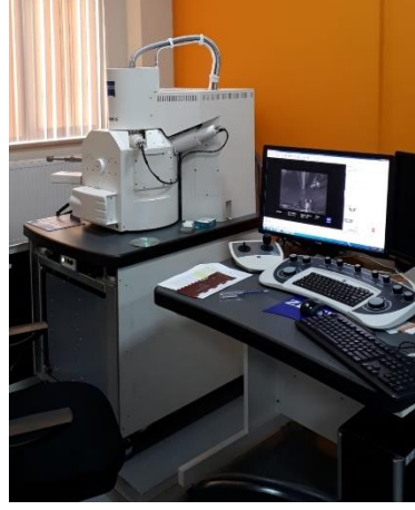
Şekil 3.8. Taramalı elektron mikroskobu (SEM) ve EDS sistemi
