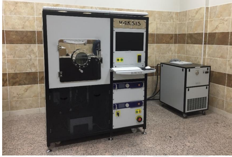
Şekil 3.4. Radyo frekans fiziksel buhar biriktirme (RF-PVD) cihazı
