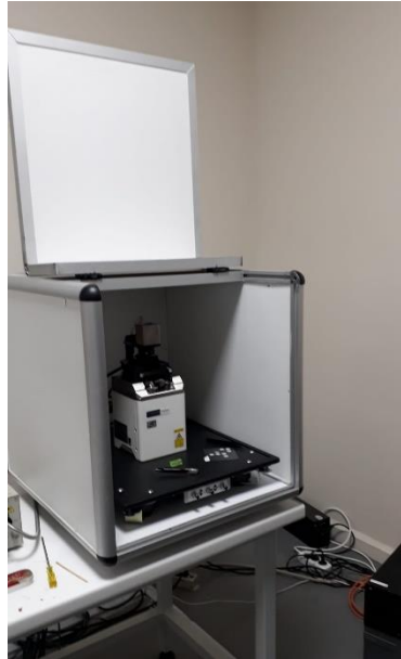
Şekil 3.9. Atomik kuvvet mikroskobu (AFM) sistemi
