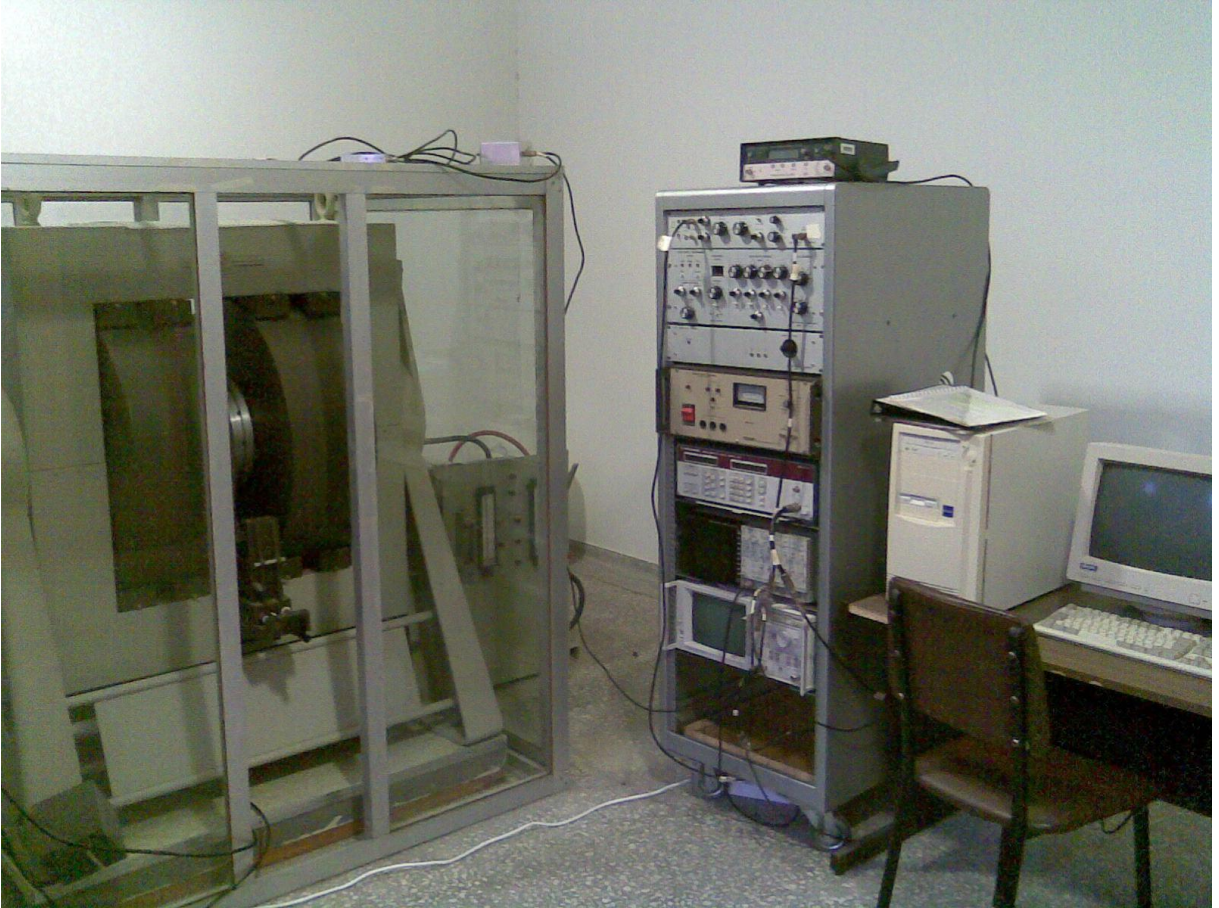
Őekil.5 Magnetik Rezonans Arařtırma Laboratuvarında kurulan ev yapımı FT NMR Spektrometresi
