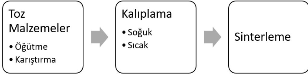
Şekil 12. Elektrik fırçası üretimi genel akış şeması
