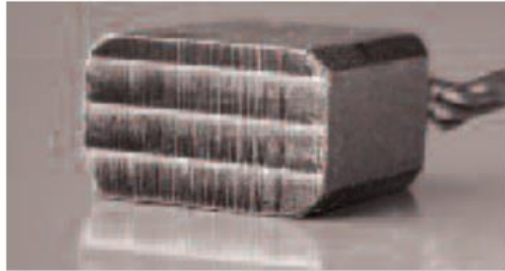
Şekil 27. Tabakalı fırça yüzey görünüşü
