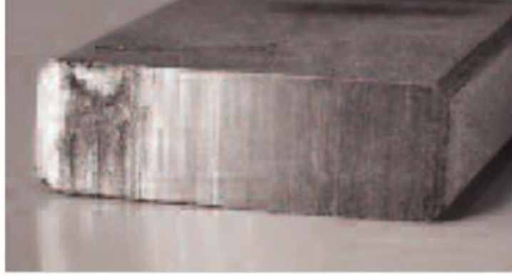
Şekil 29. Bakır parçaları birikmiş fırça yüzeyi görüntüsü
