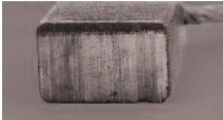
Şekil 25. Yanmış kenar hasarına ait fırça yüzey resmi
