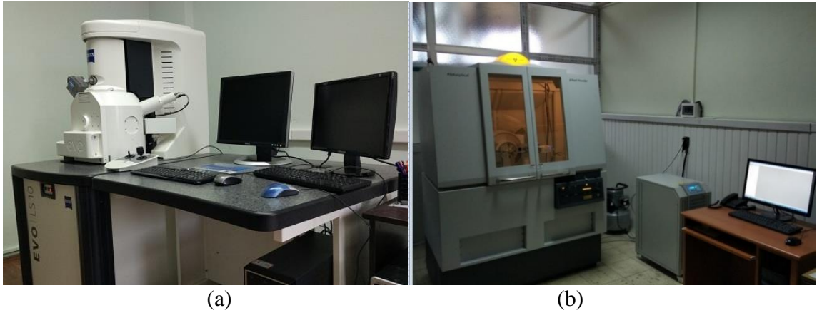
Şekil 43. a) Taramalı elektron mikroskobu (SEM) b) X ışınları kırınımı (XRD) cihazı
