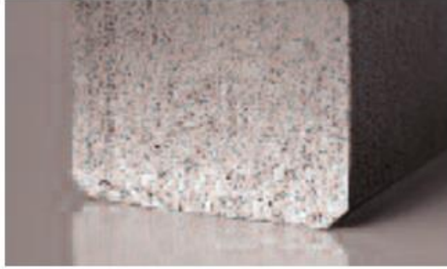
Şekil 20. Dokulu (hafif gözenekli) kayar yüzey görüntüsü
