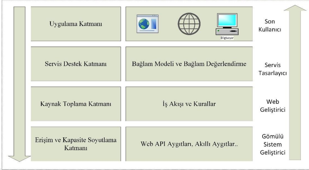
Şekil 1.4.24. Web tabanlı IoT uygulamaları için geliştirilmiş mimari model [60]
