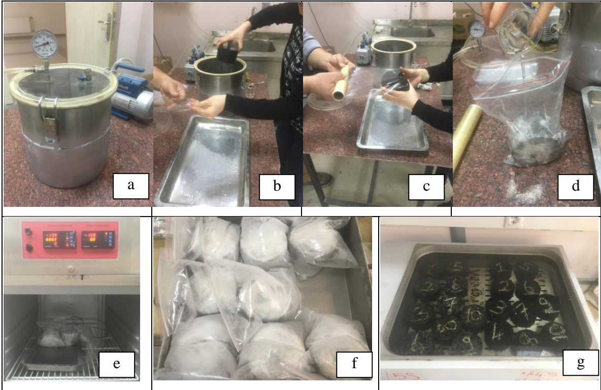
Şekil 13. AASHTO T283 koşullama aşamalarından görüntüler: a) Vakumla suya doyurma b), c) plastik film ile kaplama d) plastik poşet içerisinde su ilavesi e), f) -18^{\circ}\text{C} 'de bekletilmiş örnekler g) 60^{\circ}\text{C} su banyosunda bekletme
