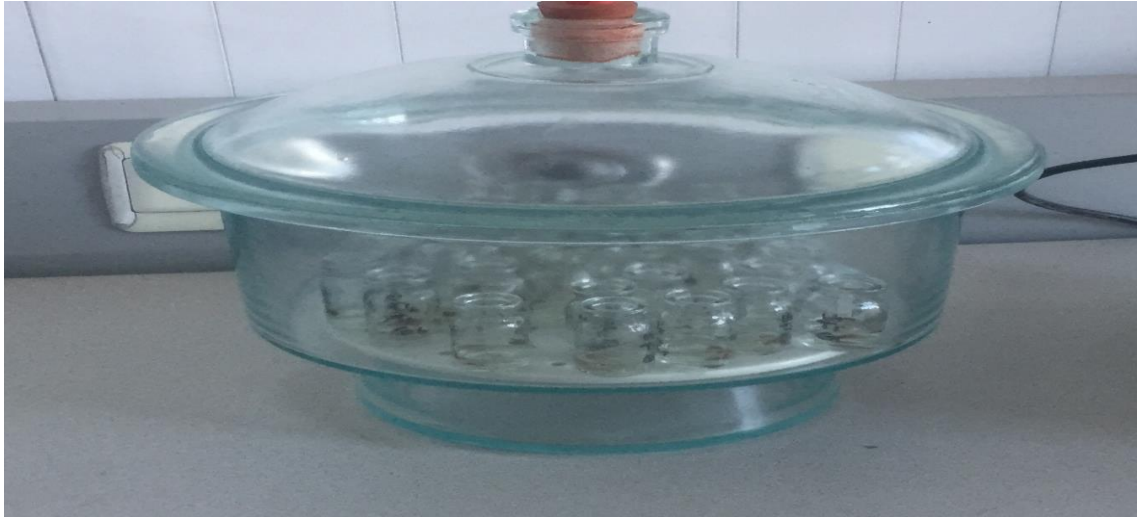
Şekil 3.8. Desikatör içerisindeki numunelerin Johansen Çözeltileri'nde bekletilmesi
