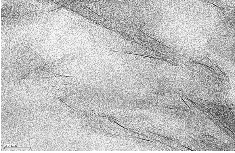
Şekil 4.12. %2 Na-MMT (ağırlıkça polimere göre) 20 kGy ışınlanarak hazırlanan hibrit hidrojel film örneklerin TEM görüntüsü
