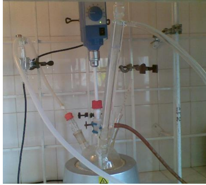
Şekil 3.3. Alkid reçine sentezinin sistematik gösterimi
