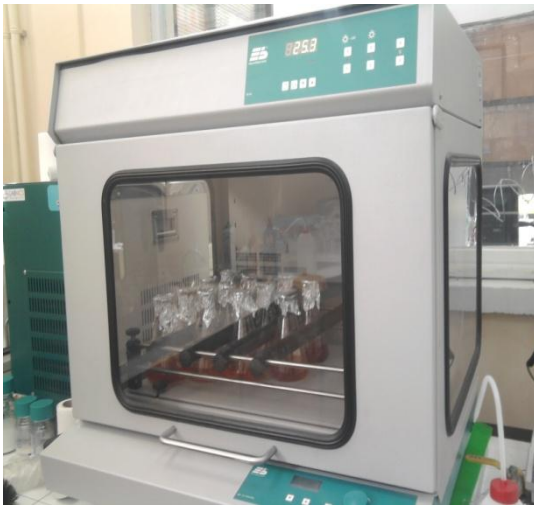
Şekil 5.1. Adsorpsiyon çalışmaları deney düzeneği
