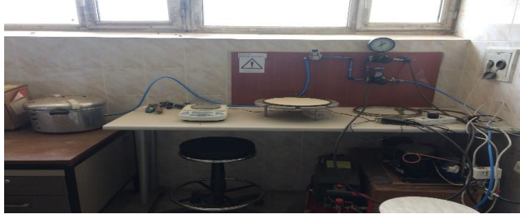
Şekil 3.9. Basınç tablası deney düzeneği
