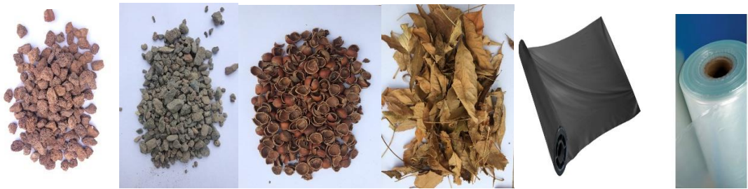
Şekil 3.3. a: Denemede kullanılan pomza (Özgün) b: çakıl malzemesi (Özgün) c: Denemede kullanılan fındık kabukları (Özgün) d: kurutulmuş yapraklar (Özgün) e: Denemede kullanılan siyah plastik f: şeffaf plastik malç malzemesi
